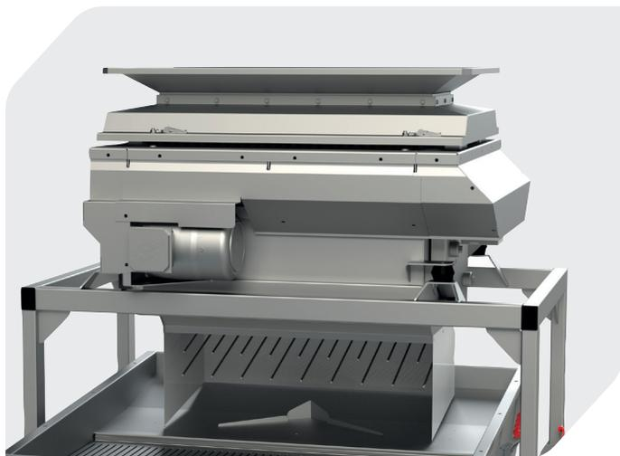
Ce système, unique sur le marché, permet de réaliser un égrenage doux et silencieux de la vendange en décrochant les baies des rafles sans le moindre traumatisme pour les deux composantes de la grappe. Il est constitué de deux rangées de doigts d'égrenage plastiques formant un couloir vertical vibrant dans lequel sont guidées les grappes (1).
