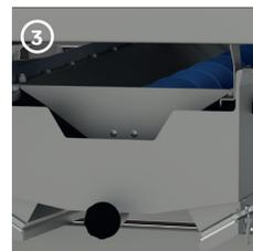
La trémie vibrante présente différents intérêts. Le premier est de contrôler la qualité des réglages utilisés au niveau de la tête d'égrenage. Le deuxième est de répartir de façon homogène la vendange sur l'ensemble de la surface de sa grille afin de tamiser efficacement les jus et les petits résidus indésirables. Le troisième est d'orienter le flux de matière à l'horizontale de façon à faciliter et optimiser le travail des rouleaux du Viniclean.
